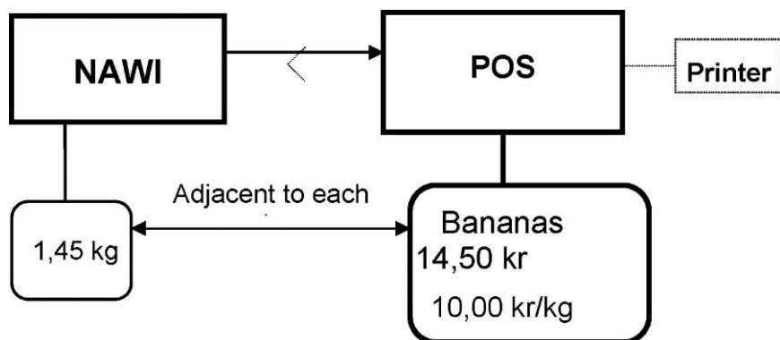
**3 NAWI vaga samo sa podacima merenja na ekranu, fiskalni uređaj sa težinom, jediničnom cenom i maloprodajnom cenu na ekranu**
