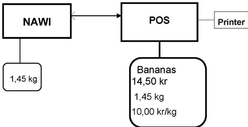
**4 Fiskalni uređaj koji ne obračunava cenu sa zajedničkim ekranom za vagu i fiskalni uređaj**
